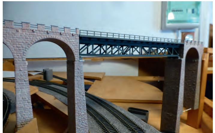
Eine das Tal überspannende Brücke mit unten liegendem Fachwerkträger liegt zu beiden Seiten auf einem gemauerten Viadukt auf.
